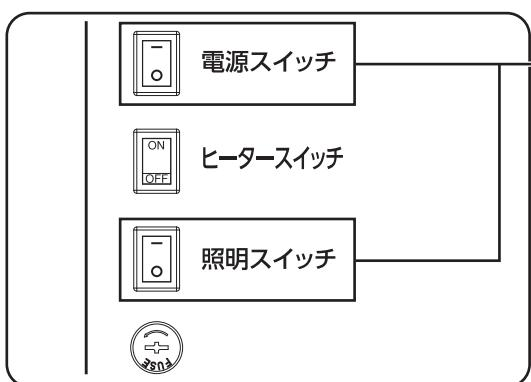
③ 背面パネルの電源スイッチと照明スイッチを「-」にしてください。
