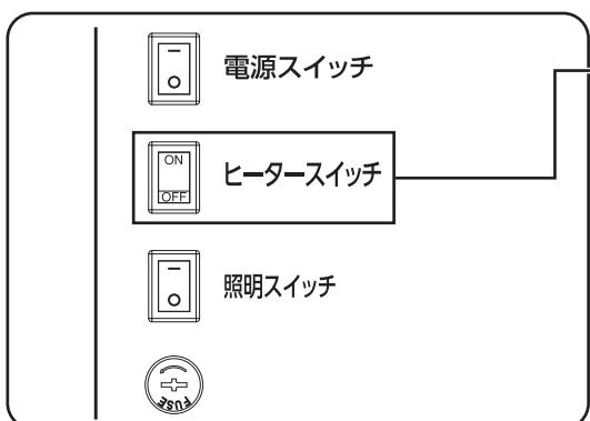
④ 給水口から水が出るようになったら、背面パネルのヒータースイッチを「ON」にしてください。
