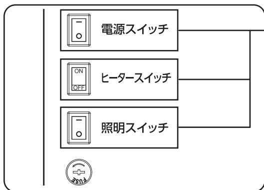
① 背面パネルの電源スイッチ、照明スイッチを「○」、ヒータースイッチを「OFF」にしてください。
