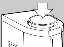
1 専用容器を強く押し込み、その上にフィルターをセットしてください。
