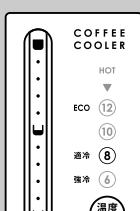
5 水温が設定温度に到達すると、温度表示ランプの点滅が点灯に変わります。
