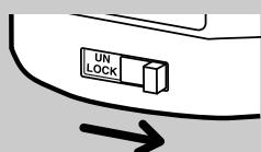
6 コップを指定位置に置き、スライドロックノブを『UN LOCK』にします。
