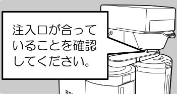
2 ウイング注入口をチャンバー抽出出口に合わせてセットします。
